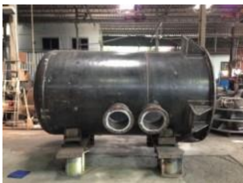
(ก) การเชื่อมถังความดัน (Pressure vessel)
