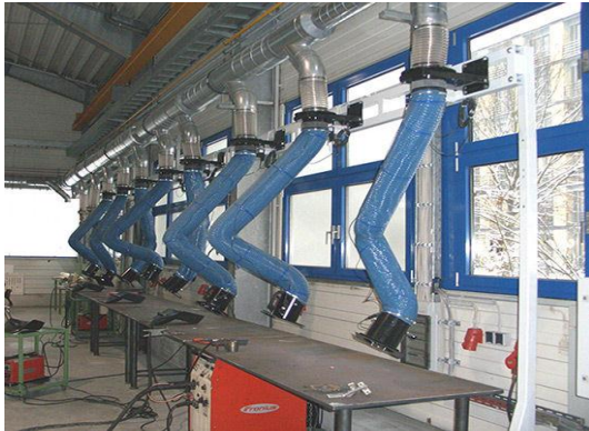
เครื่องดูดควันแบบติดตั้ง (Stationary fume extractors)
